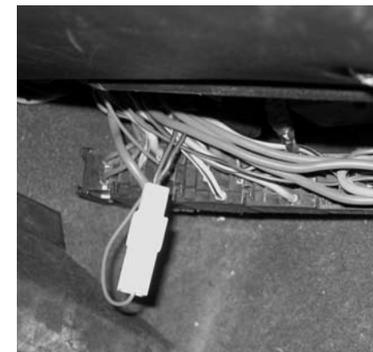
Рис. 6 Подключение управления реле вентилятора
